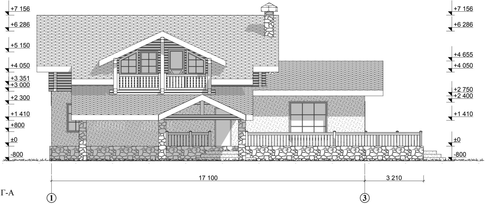
Фасад в осях Г-А
